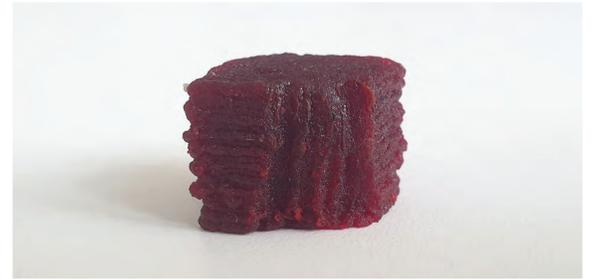
Abb. 5: Additiv gefertigter Probekörper, bearbeitet mit einem Elektro-kauter
