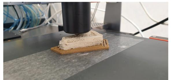
Abb. 6: Probekörper mit PLA-Holz-Stützstruktur.
