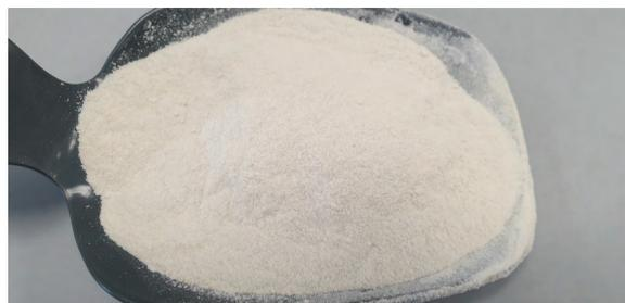
Abb. 1: Pulverförmiges thermoplastisches Kollagen (TC)
